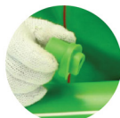
รูปการนูนขึ้นเป็นชั้นของข้อต่ออานม้า หลังจากการให้ความร้อน
